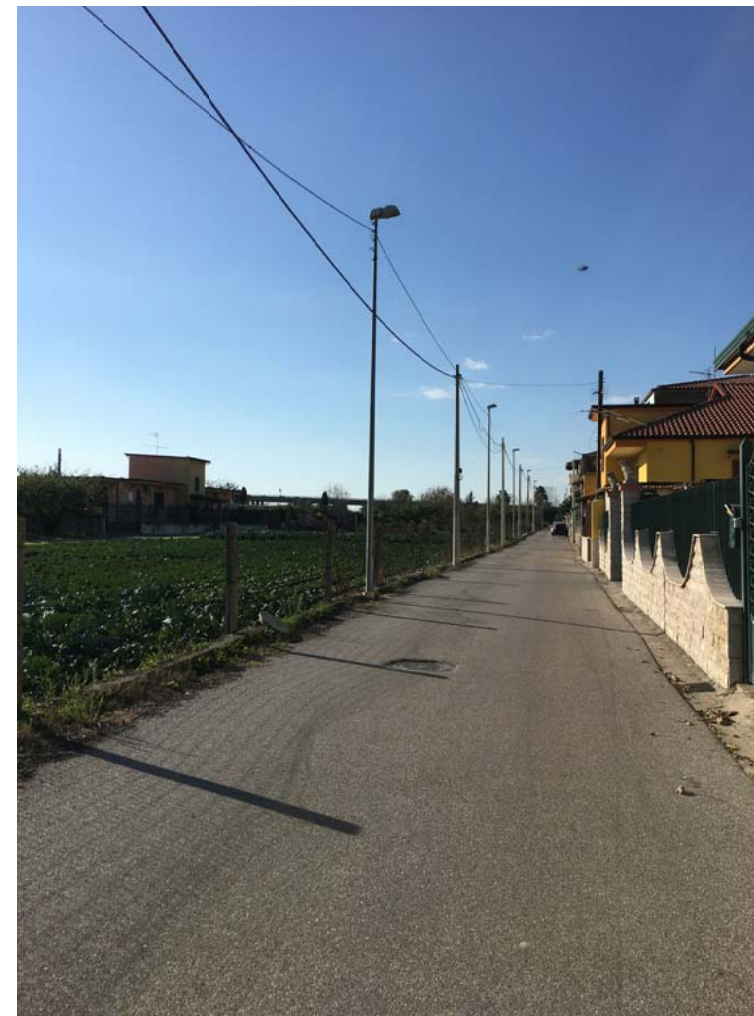
Palo Conico Diritto (h = 6,00 m)
